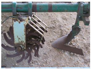
Figure 11. Rolling unit plus sweep
